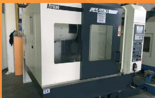
TIPO: Centro di lavoro verticale cnc MARCA: ARES SEIKI MODELLO: A7030 ANNO: 2008
